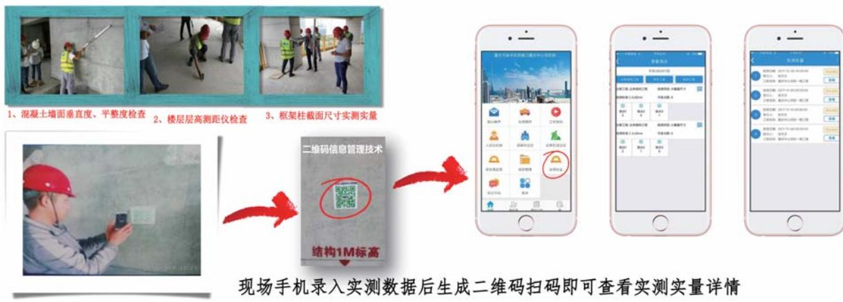
现场手机录入实测数据后生成二维码扫码即可查看实测实量详情
