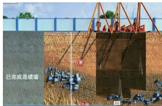
对各种地质条件及复杂的施工环境适应能力较强。施工不必放坡,不用支模,国内地下连续墙的深度已达36m,壁厚1m。
