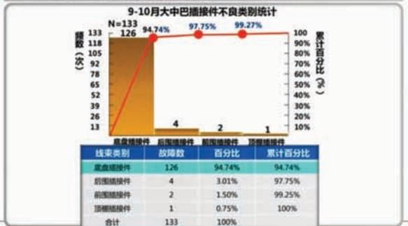
4. 针对实际底座插接件断路的不良情况，小组对9-10月份发生该126频次的底座插接件断路的不良类型进行了分析统计。
