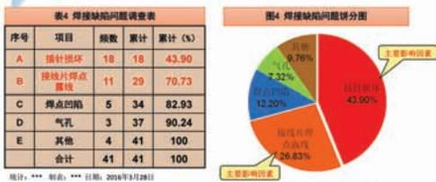
累计焊接缺陷41起,其中插针损坏和接线片焊点露线占29起,占焊接缺陷比例达70.73%,是导致焊接缺陷的主要问题。
