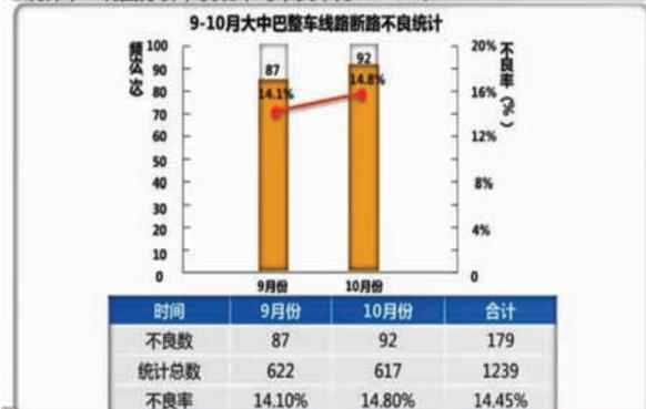
2. 针对实际生产中车辆的线路断路的不良情况，小组对9-10月份179频次的线路断路情况进行了不良部位统计。
