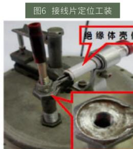
图6 接线片定位工装
